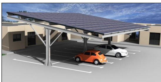
Figure 14 : Exemple d'ombrière de parking, par installation de panneaux photovoltaïques
