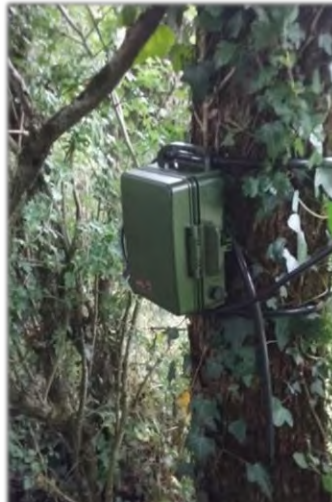
Figure 164 : Installation d'enregistreur continu SM4BAT © NCA Environnement
