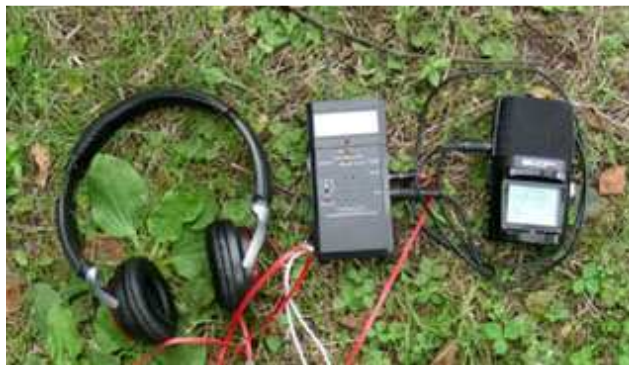
Matériel utilisé pour l'écoute des Chiroptères: Casque et D240X couplé à l'enregistreur Zoom H2N
