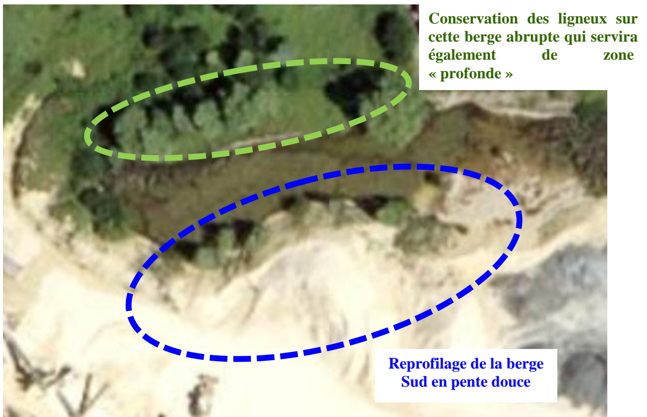
Schéma d'aménagement du bassin de décantation après exploitation
