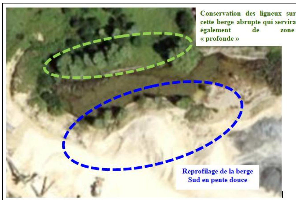
Figure 75 : Schéma d'aménagement du bassin de décantation après exploitation (Source : P. Dufrière)
